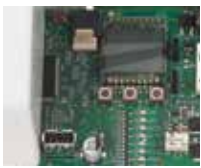
USB-poort voor updates en configuratiegegevens
